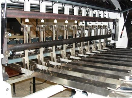
Sistema de separación de porción compuesto por una doble lengua, esta garantiza la precisa separación de las porciones y la correcta descarga a la mesa de traspaso.
