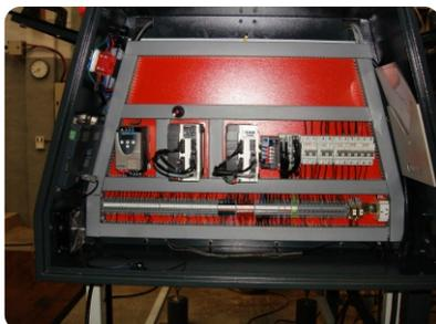
Electrónica de última generación compuesta por PLC, Drivers Inteligentes, y sistemas de protección de los circuitos eléctricos. Sistema de control de dos ejes para comandar los servomotores
