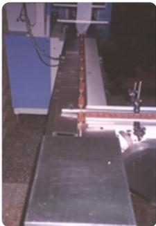
La carga a 90 es recomendada cuando se tiene poco espacio y se necesita cargar automáticamente a una envasadora, hay algunas variaciones de la misma cambiando el ángulo de entrada del producto, esto se realiza para cuidar el mismo y que el traspaso entre la maquina y el cargador sea lo mas suave posible
