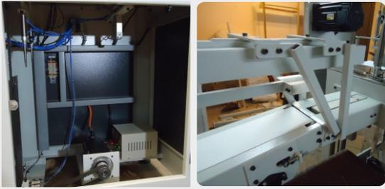
Los movimientos de la pinza de papel y del introductor de paquetes están comandados por servomotores, esto posibilita su control de los desde el panel operador logrando así poder ajustar los parámetros de los mismos de forma rápida y eficiente.
