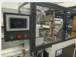
El sistema de sellado de la faja está compuesto por cuatro calefactores, que a su vez están comandados por 4 lazos de control de temperatura de forma individual, con este tipo de control logramos utilizar muy bajos micronajes en el material de la faja bajando así los costos de la misma.
