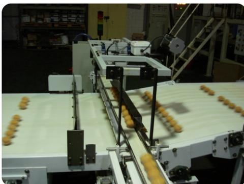
Con el producto alineado el sistema empieza a dosificar las filas de producto a los diferentes sistemas de carga, para ello cuenta con una cinta que realiza doble labor, cuando esta arriba entrega la fila de producto al sistema de traspaso y cuando esta abajo la entrega a la próxima cinta dosificadora.
