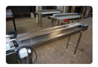
Para lograr un proceso productivo a alta velocidad desarrollamos un sistema de control y apilado, dicho sistema consta de un grupo de sensores que controlan el proceso desde los feeder hasta la salida de la máquina y le adicionamos una cinta de apilado que agrupa los conjuntos y los separa en la cantidad que el operador desee. El sistema de control notifica al operador si el conjunto prefijado tiene alguna anomalía durante el proceso, logrando así un control absoluto del mismo
