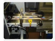
La empacadora tiene un sistema de descarte de paquetes vacíos, dicho sistema trabaja en forma totalmente automática
