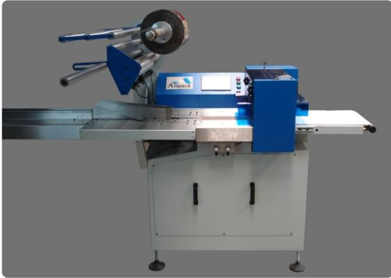
La empaquetadora W3SA es una máquina automática continua del tipo de carga horizontal.
