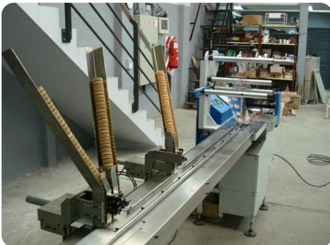
El cargador a casetera puede dosificar productos en 1 o más filas, en el caso de necesitar múltiples filas de producto se coloca un sistema lateral de carga a casetera, el mismo está sincronizado con la máquina y en cada descarga dosifica las filas requeridas.
