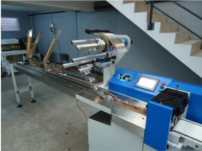
El sistema de carga a casetera es un dispositivo que va adosado a cualquier máquina Flow Pack. La función del mismo es dosificar porciones de galletas y cargarlas sincronizadamente a la máquina.
