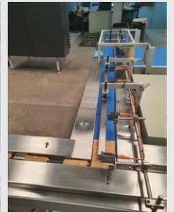
La carga a 90 es recomendada cuando se tiene poco espacio y se necesita cargar automáticamente a una envasadora, hay algunas variaciones de la misma cambiando el ángulo de entrada del producto, esto se realiza para cuidar el mismo y que el traspaso entre la maquina y el cargador sea lo mas suave posible
