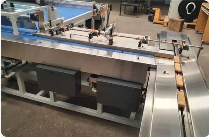
Este sistema de carga automática servocontrolado, puede ser colocado para alimentar cualquier envasadora Flow-Pack de alto rendimiento. El Cargador a 90 admite todo tipo de productos pudiéndose realizar un rápido y sencillo cambio de formato.
