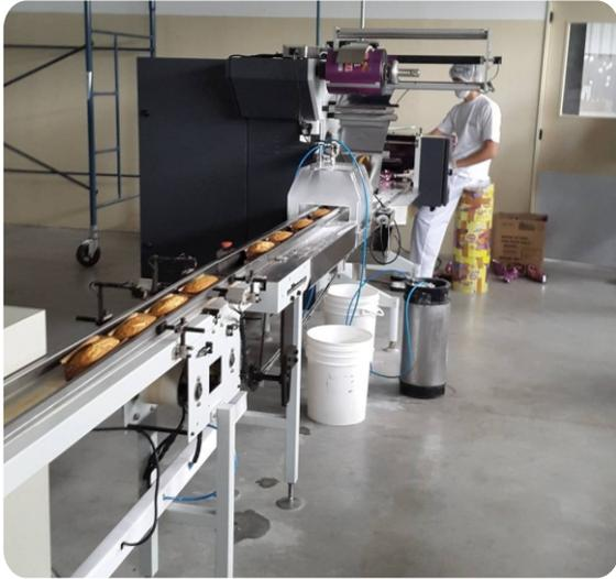
El sistema de carga de budines fue especialmente diseñado para absorber las diferencias del producto y los frecuentes cambios de peso y formato sin hacer modificaciones sobre el mismo.
