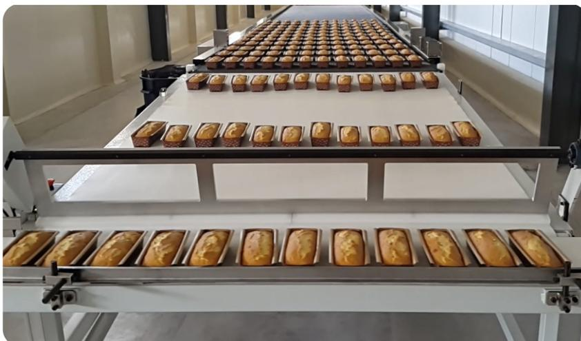
El control de todo el sistema está realizado por un PLC y por intermedio de un Panel Touch se accede a los parámetros del mismo facilitando de esta manera los cambios de formatos para los diferentes productos.
