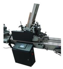
El cargador de tarjetas telefónicas fue diseñado para abastece a un sistema de empaque o de impresión de tarjetas telefónicas.
