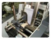
El cargador cuenta con guías laterales para contener el producto, con una pala articulada para acomodar el conjunto de las mismas y con dos tornillos micrométricos para asegurar que solo descargue de a 1 por vez
