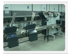
En un sistema de envasado se pueden colocar múltiples feeders La comunicación entre los mismos permite alternar y superponer las entregas de tarjetas
