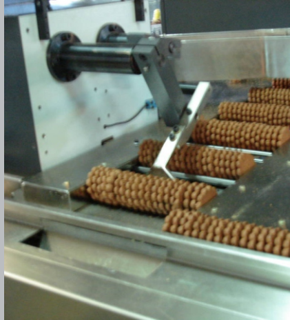
Robot de traspaso con producto y en funcionamiento.
