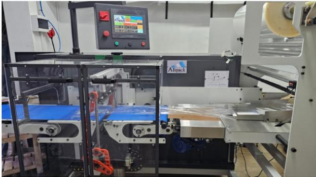
La empaquetadora W8 es una máquina automática continua del tipo de carga horizontal.
