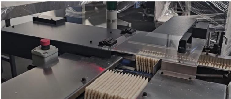
Este sistema de carga automática se diseñó para cargar las galletas de arroz a una envasadora flow pack, los movimientos del mismo son servomotorizados, asegurando un muy buen tratamiento del producto y un mínimo scrap.
