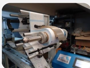
La W3 posee 4 controles de temperatura integrados en el Plc, esto colabora a la hora de utilizar papel de uso médico u otras formas de film aptos para el uso medicinal. Esto sumado al exclusivo conformador de paquete logra un excelente producto final.
