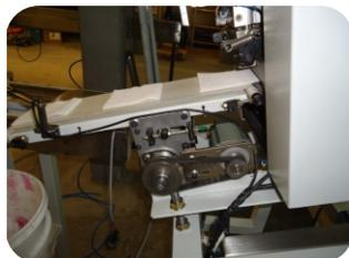
El sistema de conformación, corte y carga de gasas, esta comandado por dos servomotores, logrando la máxima exactitud en la medida de la gasa, de esta forma anulamos el scrap por sobremedida. Otro tema destacable es el mínimo mantenimiento que necesita el sistema.
