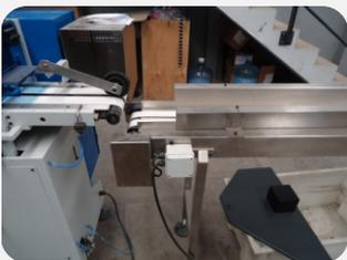
El sistema de conteo, apilado y separación de grupos de paquetes, esta formado por un grupo de sensores que detectan el sobre vacío y lo expulsan antes del sensor que cuenta el producto, luego pasan a la cinta transportadora que apila y separa en grupos, entregandole al operario de la máquina la cantidad exacta que necesita, minimizando las operaciones que este realiza y como el proceso es automático el operador puede realizar otras labores.
