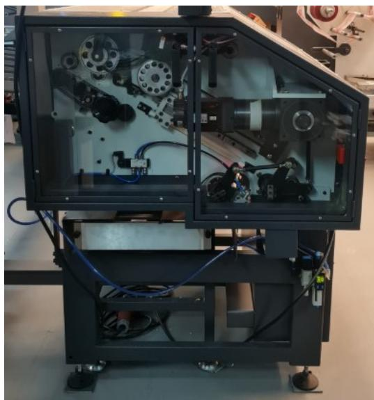
Mandos con servomotores, transmisiones simples y accionamientos a través de un manifold neumático. Esto garantiza una gran precisión en los movimientos y una alta confiabilidad con muy bajo mantenimiento.
