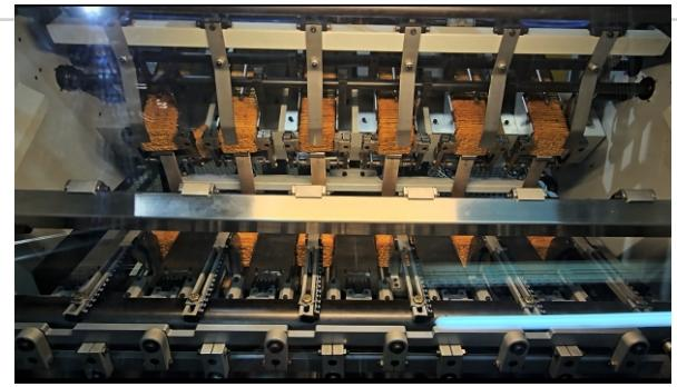
El cargador de galletas CG5-10 se adapta fácilmente a cualquier tipo de producto no importando si la galleta es con ampolla, de cereal, gruesa, fina, dulce, sin sal, salada, de agua, de soda, rellena o simple. También se le pueden adaptar fácilmente sistema de transporte por vibración y se puede girar el producto en el caso que sea rectangular.
